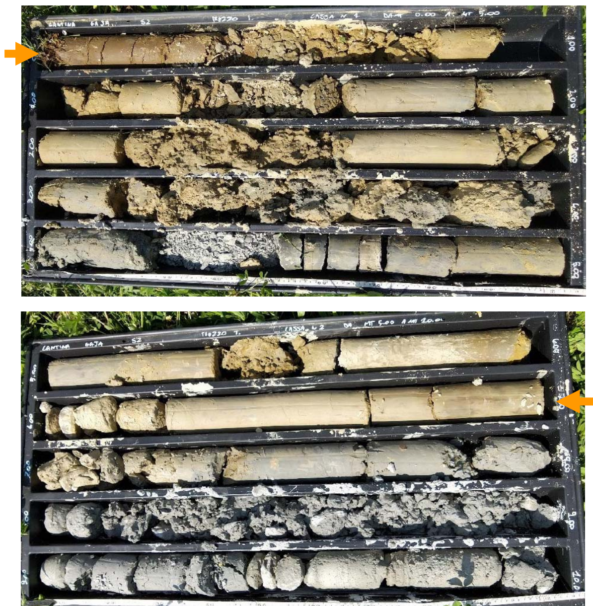
Fig. 13 – Sondaggio S2. Dal p.c. a circa -7 m terreno di copertura e substrato alterato. Oltre -7 m substrato competente, costituito da alternanze ritmiche di arenarie e peliti.
